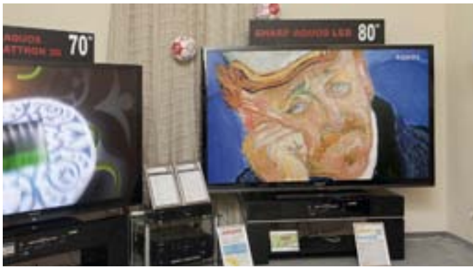
В ЖК-телевизоре Sharp LC-80LE645RU применяется уникальная технология UV2A, позволяющая добиться высокой контрастности и улучшить насыщенность чёрного цвета и яркость белого. Светодиодная подсветка в сочетании с панелью X-Gen обеспечивает самое низкое в отрасли энергопотребление (на фото — 99,4 Вт)
