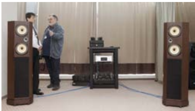
Открытая три-ампинговая система StarlingBox, удостоенная премии «Продукт Года». В акустике используются широкополосники Lowther, супертвитер, работающий до 40 кГц, и два 12-дюймовых басовика. Кроссоверы и усилители — ламповые
